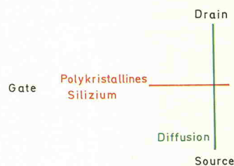
Bild 18. Die Stick-Darstellung eines MOS-Transistors vereinfacht sich auf den Kreuzungspunkt einer Poly- und Diffusionsbahn.
